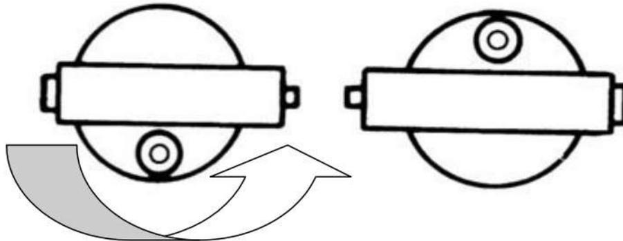
Если пузырек уровня после поворота сместился к краю, необходимо сделать юстировку. Поворачивая подъемный винт, смещаем пузырек на половину отклонения от центра уровня. Вторую половину отклонения убираем с помощью гаечного ключа, вращая два юстировочных винта.
