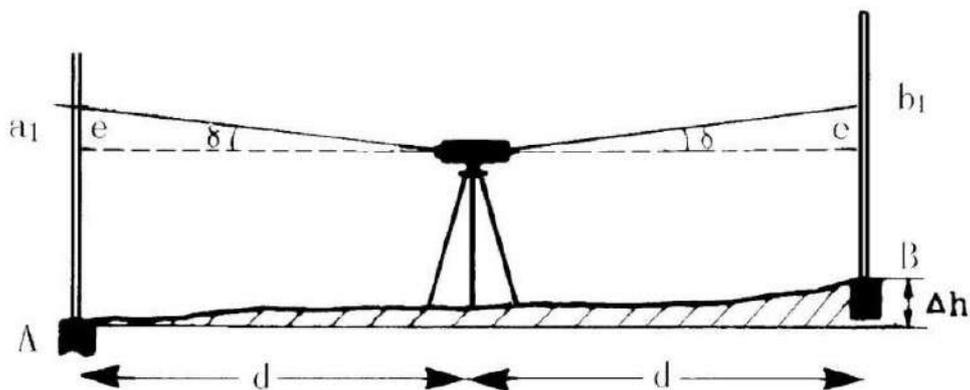
Теперь установите инструмент на расстояние 1-2 метра от рейки В и возьмите отсчет  $b_2$  по рейке В и отсчет  $a_2$  по рейке А. Если разница  $(a_2 - b_2) - (a_1 - b_1) \leq 3 \text{ мм}$ , то инструмент не нуждается в юстировке.
